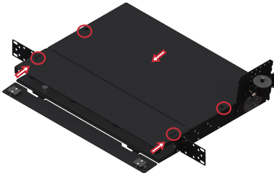
Fig. 32 Colocación de cubiertas superiores
