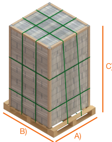
Fig. 3: Estibado estandar. (5 cajas por cama y 15 camas)
