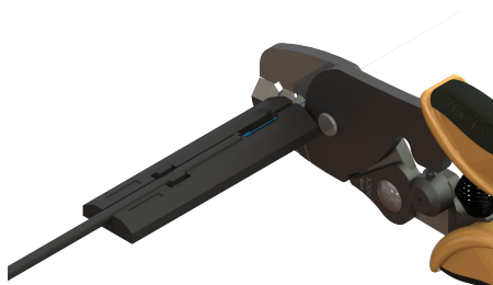
PASO 4 : Colocar el cable en el JIG de corte y desforrar completamente la fibra..
