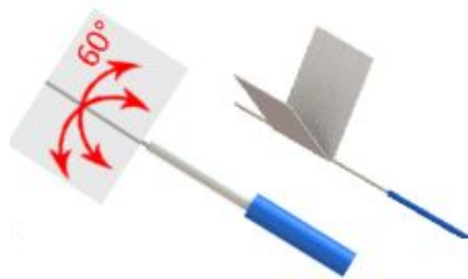
PASO 5 : Limpiar la fibra con una toalla y alcohol isopropilico retirando los excedentes, cuidando no dañar la fibra.
